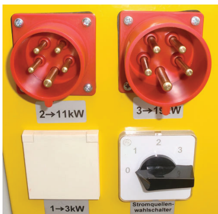
Afbeelding: Verwarmingsvermogen vaststellen en keuzeschakelaar stroombron instellen
